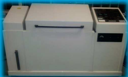
Korozní zkoušky Korozní komora Liebisch STR-400 920x590x740 mm
