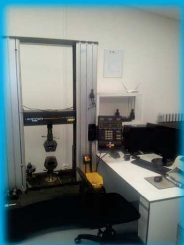
Mechanické zkoušky Trhací stroj Instron 4482 100 kN
