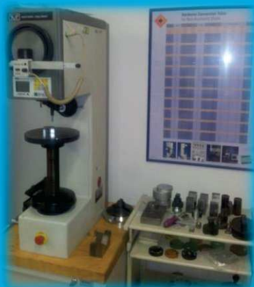
Měření tvrdosti Tvrdoměr Wilson-Wolpert TESTOR 930/250
