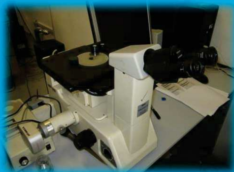
Metalografické zkoušky Inverzní metalografický mikroskop Nikon Epiphot 200
